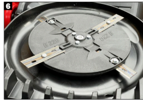
5 (5) Bewegliche kleine Messer, die leicht zu wechseln sind, haben sich zum Standard bei den Mährobotern entwickelt (6) Al-Ko setzt bei seinem Rasenmähroboter auf feste Messer, die dafür viel kräftiger sind
