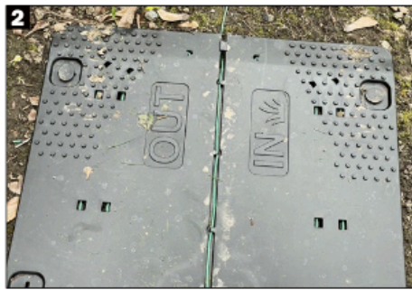
1 (1) Der Yard Force Xpower 800 kommt mit Wechselakku, der auch bei anderen Geräten des Herstellers funktioniert (2) Vorbildlich: Die Basisstation des Scheppach zeigt an, wie sie positioniert werden muss (in/out)
