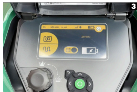
3 (3) Über das farbige Touch-Display kann der Robomow sehr leicht programmiert und bedient werden (4) Die App des Al-Ko-Mähers ist leicht verständlich und bietet auch Anbindung an weitere smarte Dienste wie Alexa und Home Connect Plus
