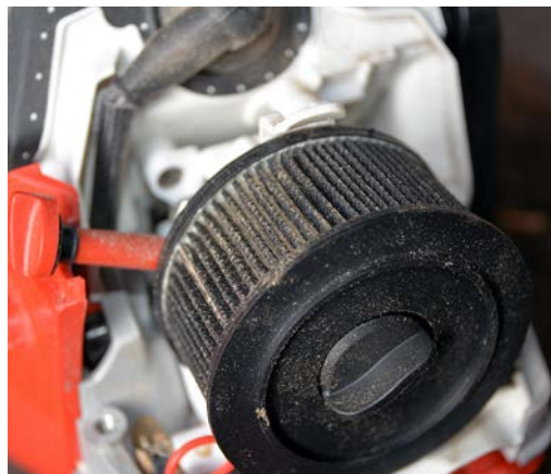
Der Lamellenluftfilter überzeugt mit einer sehr großen Filterfläche. Auch nach sieben Tankfüllungen gelangte im Test kein Schmutz in den Ansaugtrakt vor dem Vergaser (unten).
