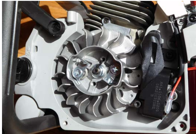
Vorbildlich: Die Ansaugluftvorabscheidung separiert schwere Schmutzpartikel.
