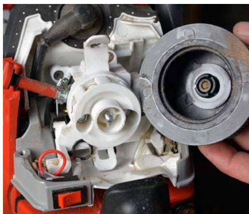
Der Lamellenluftfilter überzeugt mit einer sehr großen Filterfläche. Auch nach sieben Tankfüllungen gelangte im Test kein Schmutz in den Ansaugtrakt vor dem Vergaser (unten).
