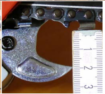
Anekdote am Rande: Die Kupplung der 6646 (rechts) ist komplett baugleich mit der Kupplung der Dolmar PS-5105/6100. Vermutlich noch ein Relikt der Zusammenarbeit dieser beiden Kettensägenhersteller.
