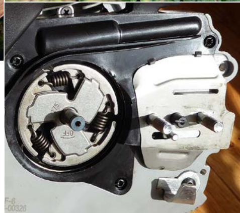
Anekdote am Rande: Die Kupplung der 6646 (rechts) ist komplett baugleich mit der Kupplung der Dolmar PS-5105/6100. Vermutlich noch ein Relikt der Zusammenarbeit dieser beiden Kettensägenhersteller.
