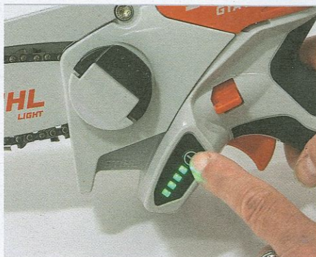
+ IDEAL: Bei Stihl ist die verbleibende Akkuladung leicht abzulesen.
