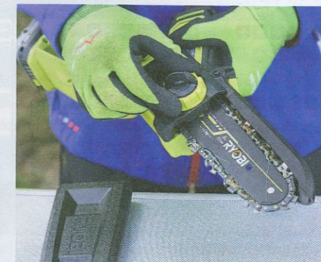
+ PRAKTISCH: Werkzeuglos einstellbare Kettenspannung an der Ryobi-Säge.
