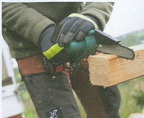
- STOPP: Die Billigsäge bleibt in dicke-m Holz immer wieder stehen.
