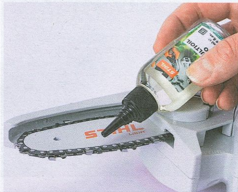
- LÄSTIG: Bei einigen Geräten muss manuell nachgeölt werden – hier Stihl.
