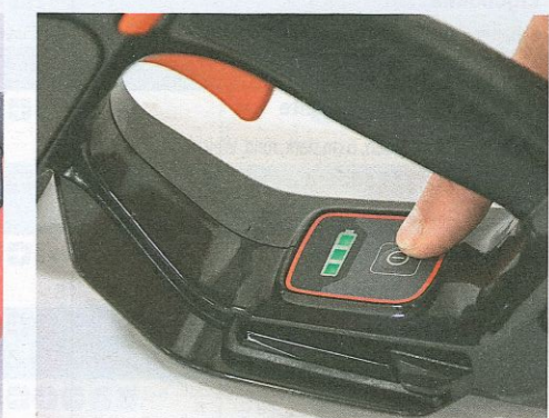
+ SICHER: Die Husqvarna-Säge muss gesondert eingeschaltet werden.
