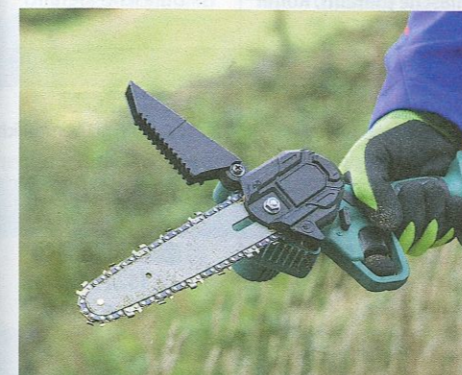
- GEFÄHRLICH: Beim Billigerät ist der Schutz zu kurz und funktioniert nicht.
