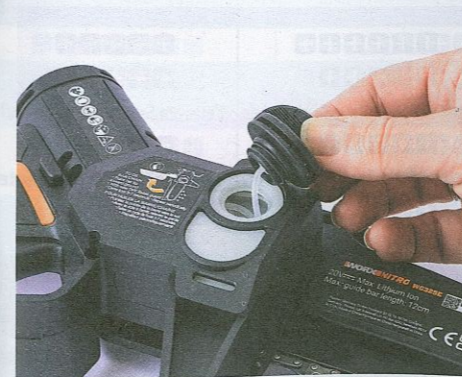
+ VERBUNDEN: Der Ölverschluss bei Works ist verliersicher befestigt.
