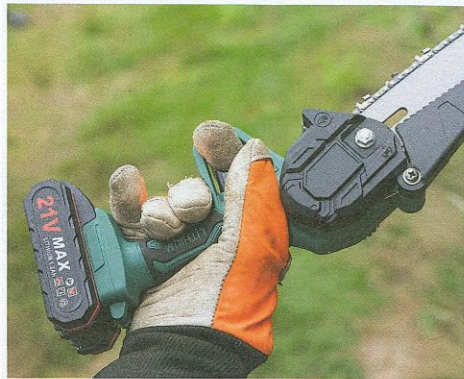
- KLEIN: Der Griffbereich der billigen Noname-Säge ist deutlich zu eng.
